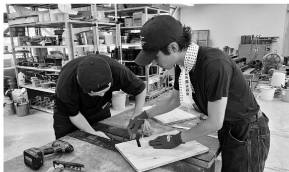
図 5-4 合板を組み合わせるための原寸大模型を作りディテールを確認
